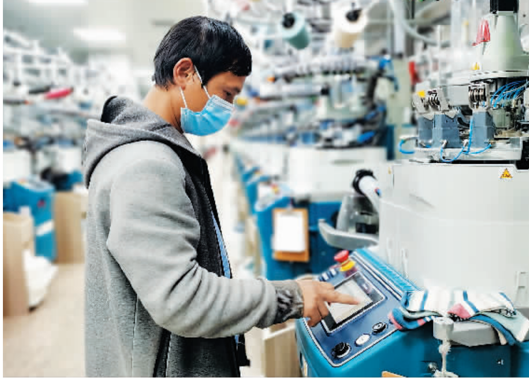
友邦袜业的对目机器昼夜运作,完成袜子封口工作。每台机器每天可生产300双袜子。
