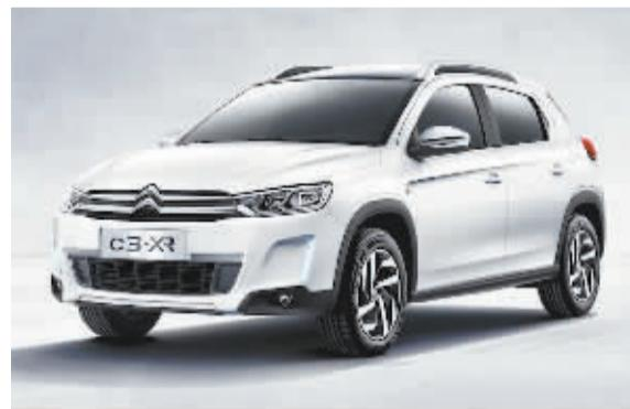
C3-XR可在不影响消费者用车习惯的情况下,通过在怠速时自动关闭发动机实现节油15%。
