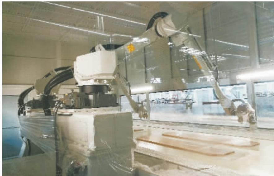
天坛家具新工厂处处弥漫着科技气息。图为两个机器人在同时作业,通过3D扫描,它们可以对任何形状部件进行均匀喷涂。
