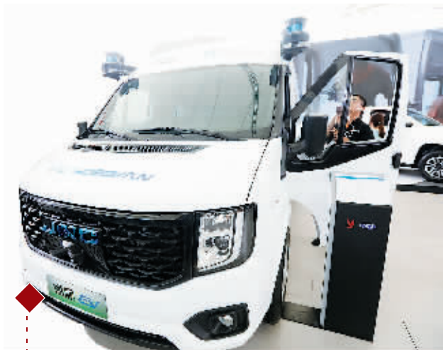
6个激光雷达和12个摄像头感知道路及周围情况
